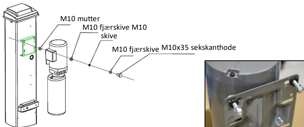
Figur: Montering av motorenheten
