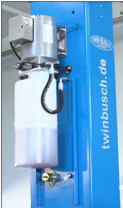
Figur: Montering av motorenheten
