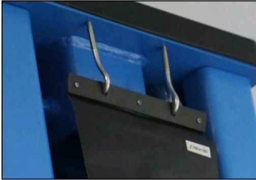
Figur: Montering av kjede og dørstoppbeskyttelse
