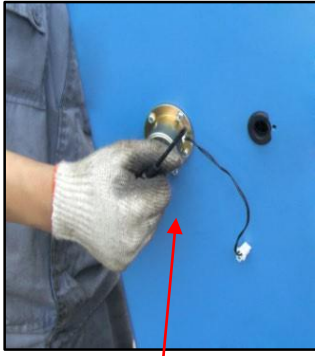
Elektromagnet på den ytre overflaten av søylen
