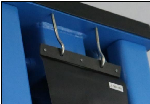
Figur: Montering av kjede og dørstopbeskyttelse
