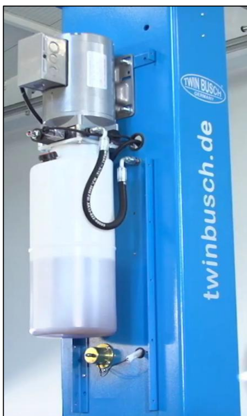
Figur: Montering av motorenheten
