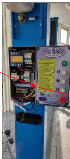
Figur: Koble strømforsyningen til kontrollenheten
