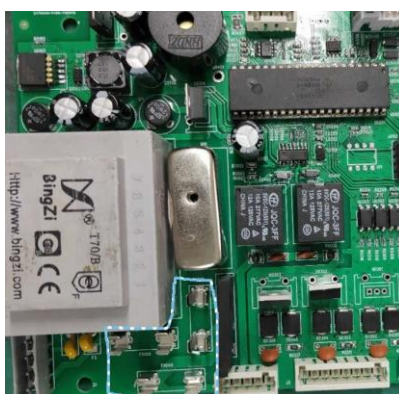
Fig.18 Sikring på kontrollkortet
